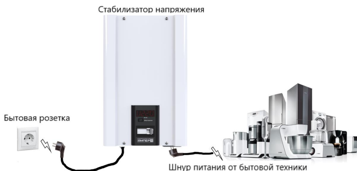
Рисунок 13. Подключение стабилизатора к сети
